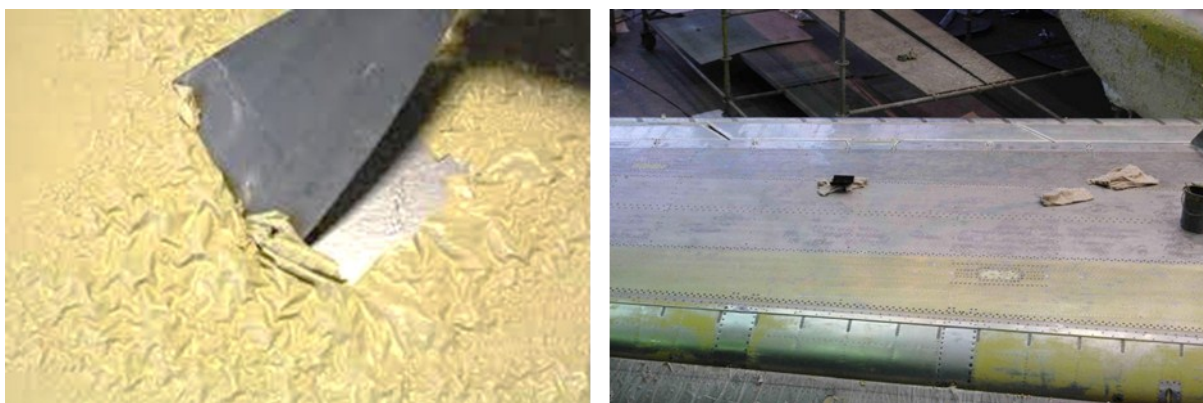
Рис. 1. Технологический процесс удаления ранее нанесенных лакокрасочных покрытий
