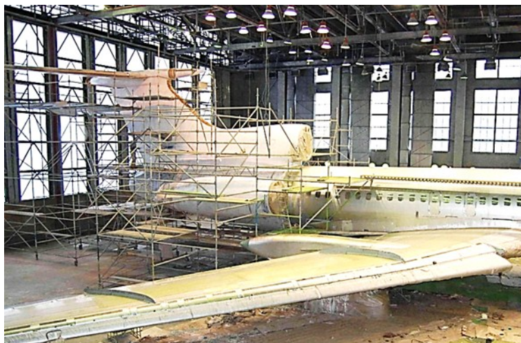
Рис. 3. Технологический процесс нанесения покрытий на воздушное судно
