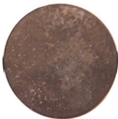
Рис. 3. Внешний вид образца из сплава ВЖЛ21 с защитным покрытием СДП-1Т+ВСДП-13 после 40 циклов испытаний на сульфидно-оксидную коррозию при 900^\circ\text{C}
