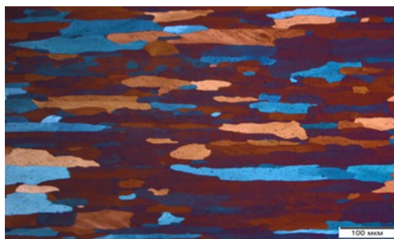
Рис. 1. Типичная микроструктура листа из сплава В-1480 (направление Π)
