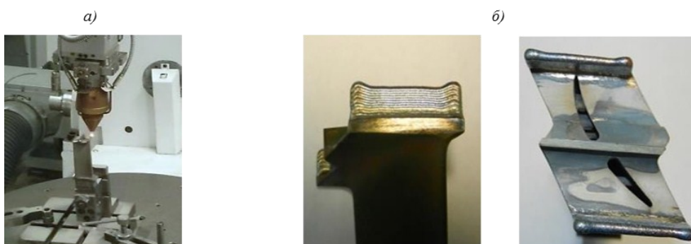
Рис. 9. Процесс лазерной газопорошковой наплавки (а) и внешний вид (б) восстановленных крайних гребешков бандажных полок лопаток ТВД
