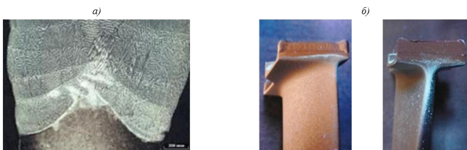
Рис. 11. Микроструктура (а) и результаты люминесцентного контроля (б) восстановленных гребешков рабочих лопаток ТВД лазерной газопорошковой наплавкой
