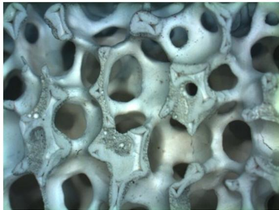
Рис. 1. Фрагмент пенoкeрaмичeскoгo филтpa в иcхoднoм cocoянии (пpoдoльнoe ceчeниe)
