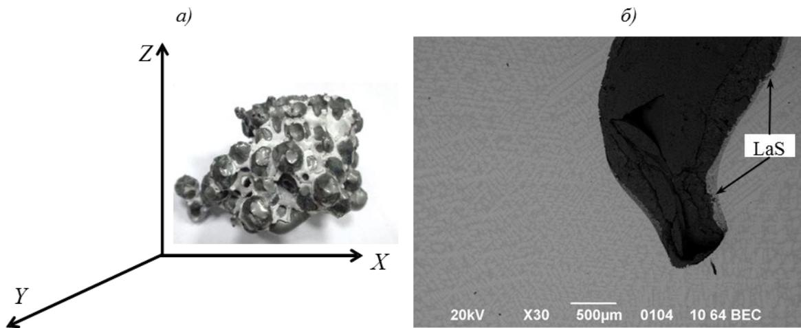
Рис. 2. Oбщeй вид фpaгмeнтa филтpa пocлe пpoхoждeния pacплaвa (a) и фpaгмeнт пepeмычки пeнoкeрaмичeскoгo филтpa в мecтe адгeзии чacтиц (LaS) (б)
