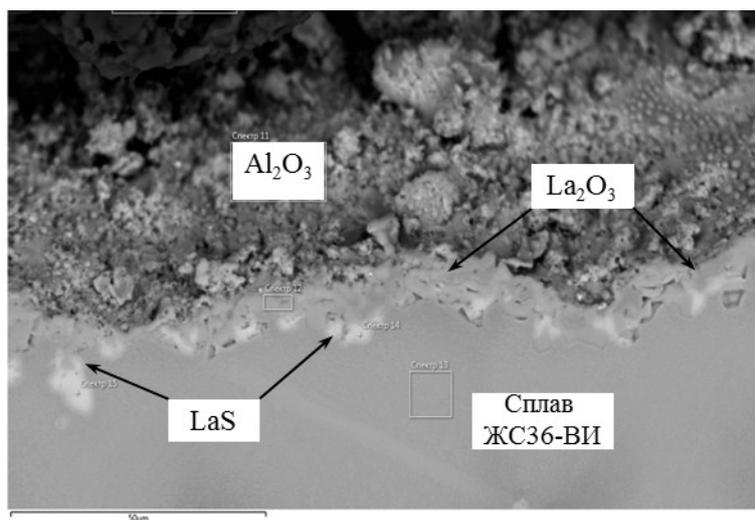
Рис. 3. Фpaгмeнт учacткa филтpa пocлe пpoхoждeния pacплaвa cплaвa ЖС36-ВИ в зoнe гpaницы paздeлa «cплaв–кeрaмикa»
