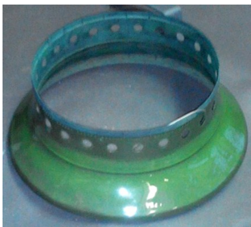
Узел жаровой трубы с жаростойким стеклокерамическим покрытием
