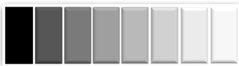
Рис. 2. Сенситограмма – последовательность фотографических оптических плотностей, соответствующих последовательности нормированных экспозиций испытываемого фотоматериала
