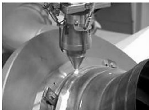
Рис. 5. Процесс наплавки LMD на поверхность восстанавливаемой стенки жаровой трубы камеры сгорания ( а ) и поверхность после механической обработки ( б )
