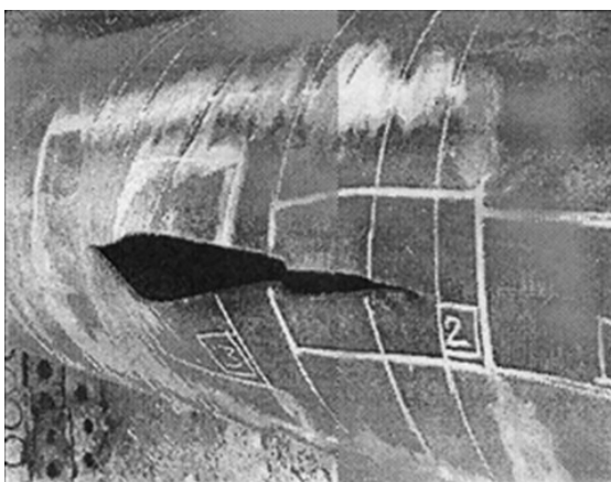
Рис. 2. Общий вид испытанной трубы из стали X70
