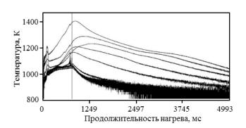
Рис. 2. Термограмма процесса электротермического взрыва в сборочном образце 3 с толщиной фольги из титана и алюминия соответственно 100 и 10 мкм
