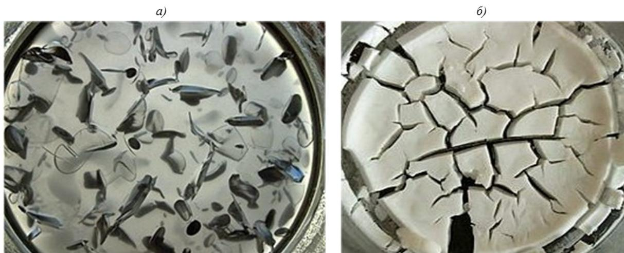
Рис. 6. Вид геля с содержанием иттрия 50% в процессе старения (а) и после сушки (б)
