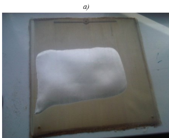
Рис. 4. Вид плиты, имеющей предварительную плотную упаковку из ткани (а) и вид плиты, полученной с использованием свободного пространства в пресс-форме при пропитке (б)
