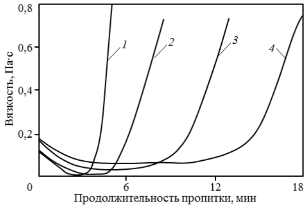
Рис. 2. Критические кривые вязкости при температуре 100 (1), 90 (2), 80 (3) и 70°C (4)
