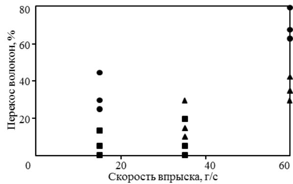
Рис. 3. Зависимость предела отклонения перекося волокна от скорости подачи смолы и предварительной пропитки концентратом связующего с содержанием 4 (▲) и 8% (■); ● – без пропитки концентратом
