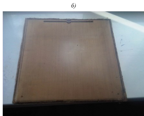
Рис. 4. Вид плиты, имеющей предварительную плотную упаковку из ткани (а) и вид плиты, полученной с использованием свободного пространства в пресс-форме при пропитке (б)
