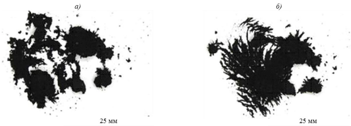
Рис. 1. Внешний вид порошков синтезированного нанокompозита в исходном состоянии (а) и после кратковременного воздействия на образец постоянного магнитного поля (б)
