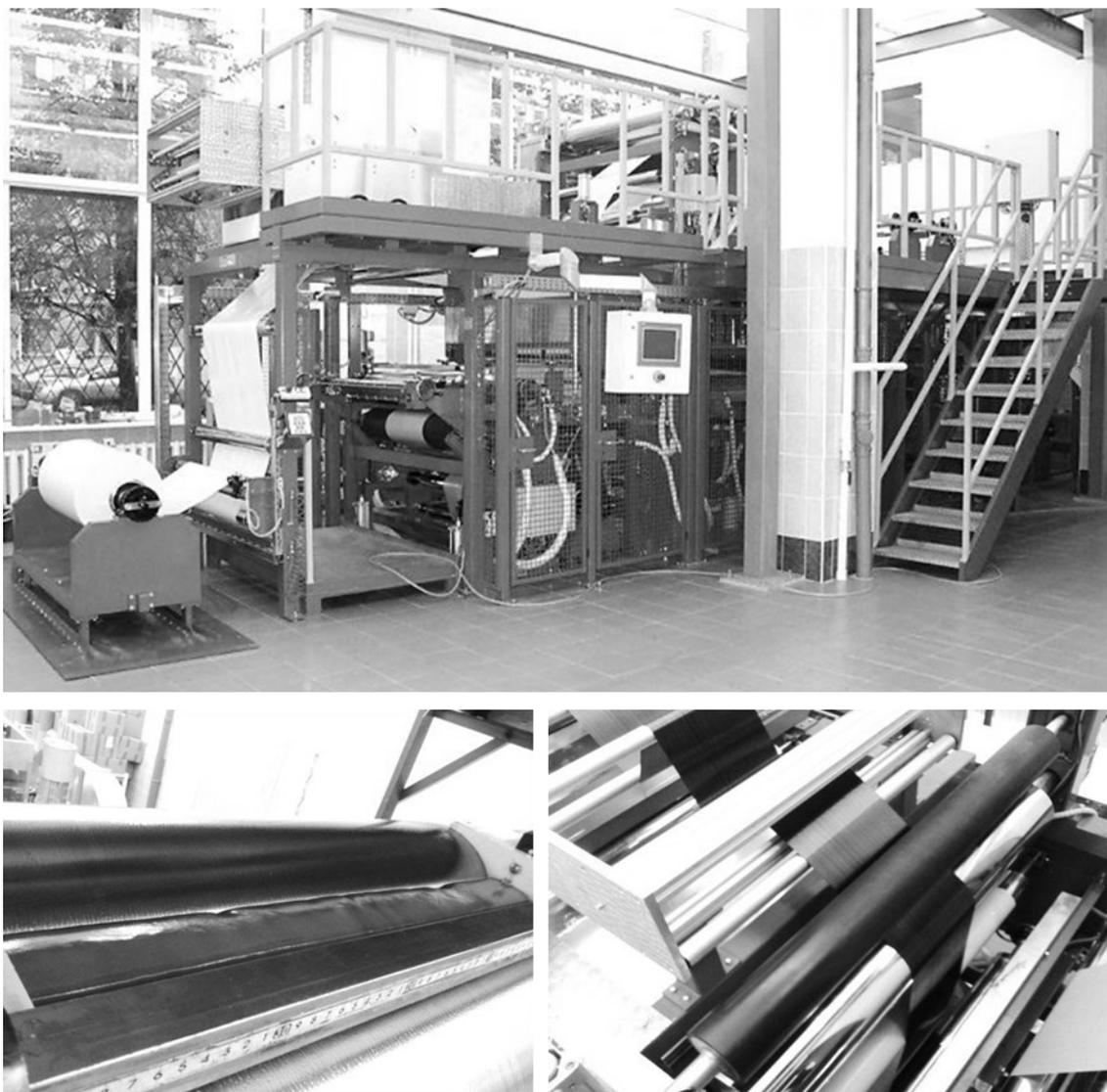
Рис. 1. Производство препрегов с использованием расплавных связующих (ФГУП «ВИАМ»)
