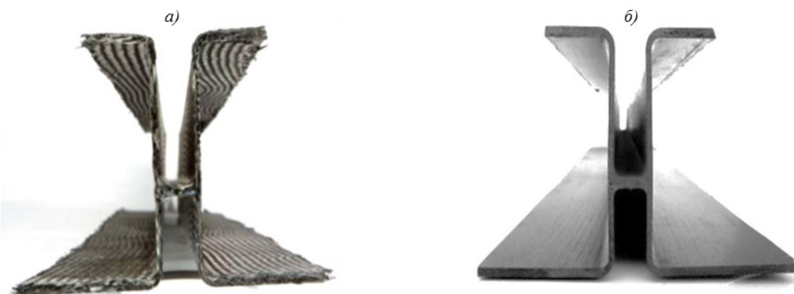
Рис. 2. Тканая объемно-армирующая преформа (а) и образец изделия (б) на ее основе (фирма Albany Engineered Composites, США)
