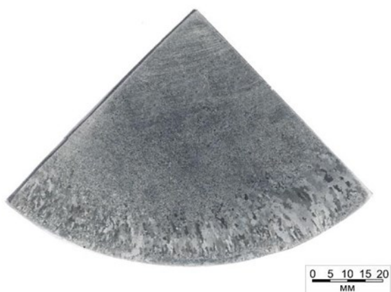
Рис. 3. Внешний вид экспериментальных слитков после тройного переплава: a – орто-сплав Ti–25Al–23Nb–3,5(Zr+V+Mo+W)–1,2(Si+C); б – \gamma -сплав Ti–47Al–2Nb–2Mo–2V–2Zr–2Cr–0,2(B+C)–0,2Gd
