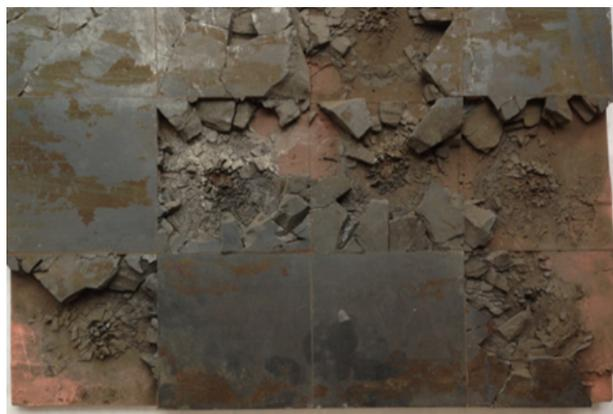
Рис. 4. Характер разрушения конструкции из карбида кремния и Органита ВКО-2ТБ
