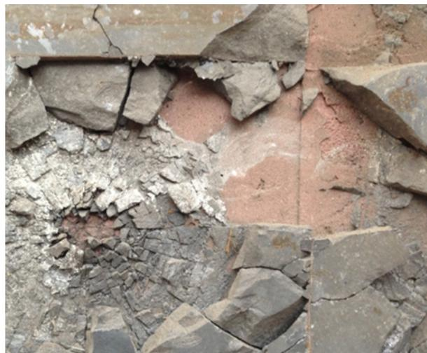
Рис. 2. Разрушение керамической пластины вне зоны импульсного нагружения
