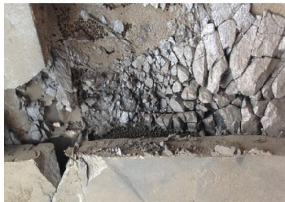
Рис. 3. Фрагменты разрушенного керамического элемента после импульсного нагружения
