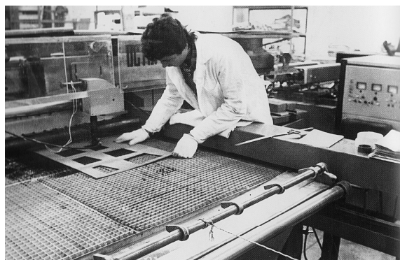
Рис. 3. Лазерная установка для раскроя материала АТМ-15ПК
