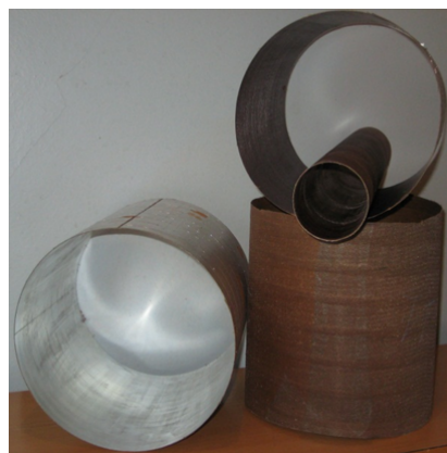
Элементы труб с различными покрытиями для защиты от накопления статического электричества
