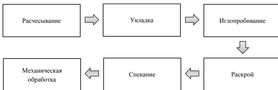
Рис. 1. Технологическая схема получения панелей из ПВММ
