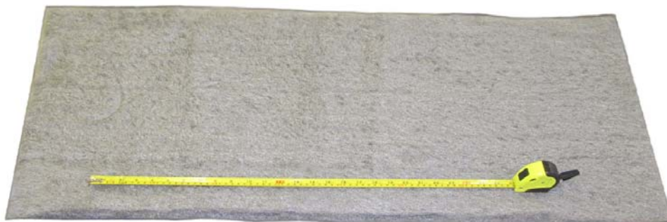
Рис. 4. Мат из ПВММ с пористостью более 95%
