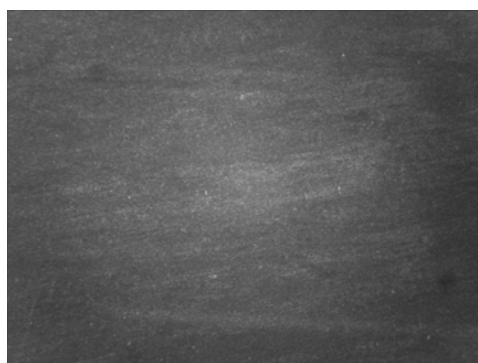
Рис. 1. Макроструктура листа из сплава BT23M толщиной 1,8 мм после обработки по режиму: ВТМО+старение при T_{п.п} -400°C
