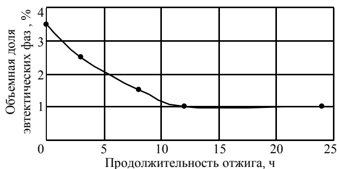
Рис. 2. Зависимость объемной доли эвтектических фаз в сплаве с добавкой Ag при температуре гомогенизации от продолжительности отжига
