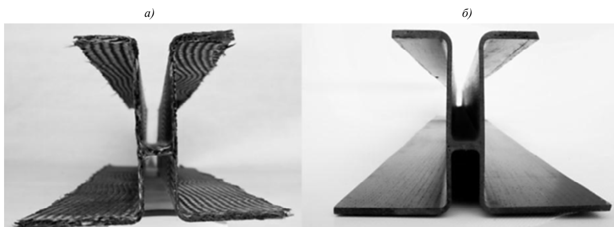
Рис. 2. Текстильная объемно-армирующая преформа (а) и образец (б) изделия на ее основе (фирма Albany Engineered Composites, США)
