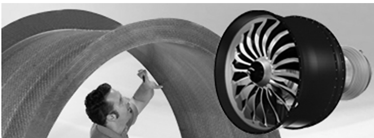
Рис. 6. Элемент корпуса вентилятора авиадвигателя, произведенный компанией АЕС (совместно с компанией Spesta), изготовленный с применением объемно-армирующих преформ
