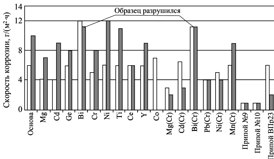
Рис. 1. Влияние легирующих элементов на коррозионную стойкость цинковых припоев системы Zn–7Al–3,7Cu при испытании в течение 1 мес в камере солевого тумана (□) и в 3%-ном растворе NaCl (■)
