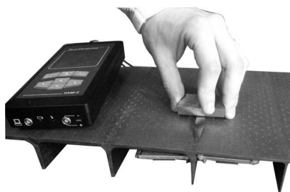
Рис. 2. Ультразвуковой контроль углепластиковой панели, подкрепленной ребрами, низкочастотным акустическим велосимметрическим методом
