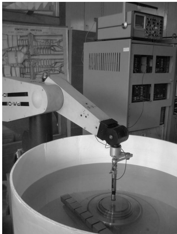
Рис. 1. Ультразвуковой контроль заготовок дисков из деформируемых жаропрочных никелевых сплавов типа ВЖ175 с помощью автоматизированной установки
