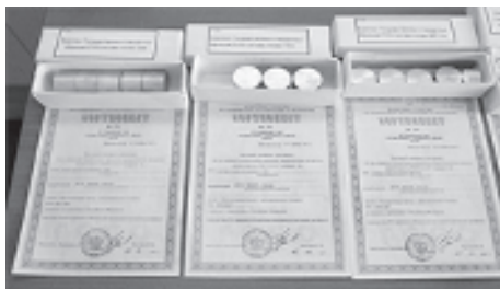
Рис. 2. Комплекты ГСО сплавов АЛ9, 1163 и МЛ5
