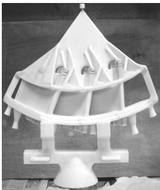
Рис. 1. Модельный блок в сборе со стартовым основанием и заливочной чашей
