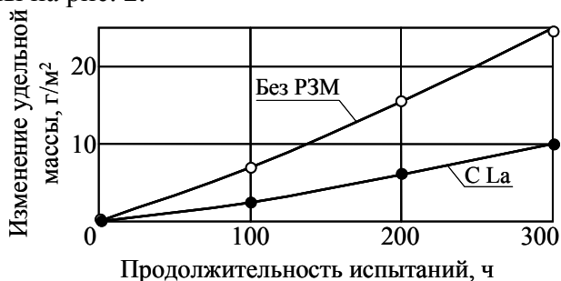
Рис. 2. Влияние микролегирования сплава ВКНА-25-ВИ (МОНО <111>) лантаном на жаростойкость при температуре 1100°C
