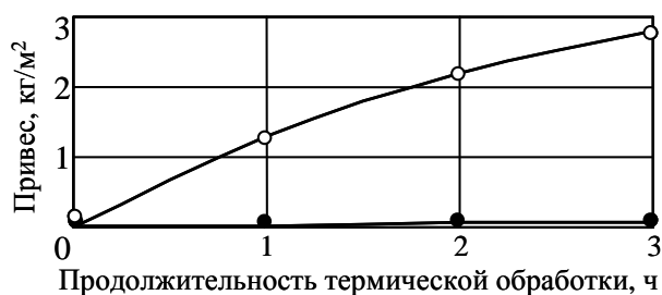
Кинетика окисления стали типа ВКС при полном цикле термической обработки без покрытия (○) и с покрытием ЭВТ-77М (●)
