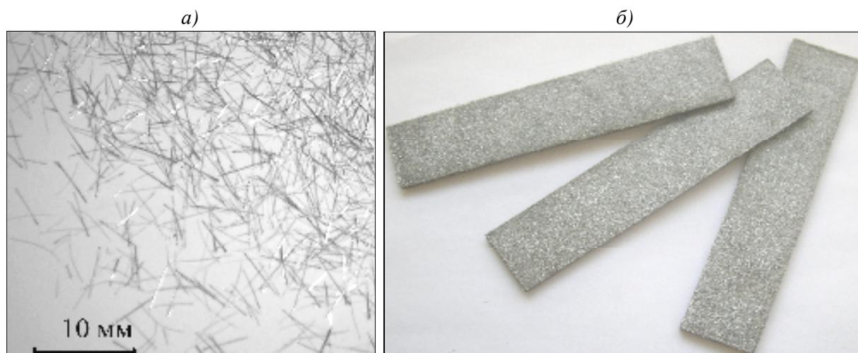
Рис. 1. Металлические волокна и образцы уплотнительного материала:
