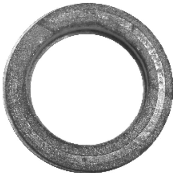
Рис. 2. Образец уплотнительного материала из металлических волокон после испытания на врезание
