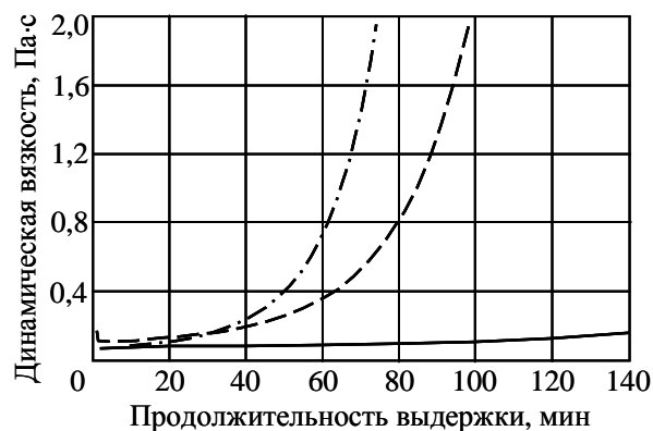
Рис. 2. Зависимость изменения вязкости эпоксидных VARTM- (---) и RTM-связующих (-.-) и полициануратного RTM-связующего (—) от продолжительности выдержки при 80°C
