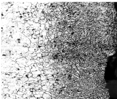
Рис. 8. Микрошлиф (×200) алюминиевого листа в трехслойном АЛОР Д16/41 в прилегающей к кромке реза зоне
