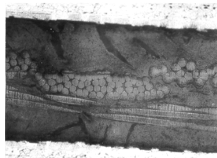
Рис. 9. Микрошлиф (×100) клеевого слоя в трехслойном АЛОР Д16/41 из зоны термического воздействия
