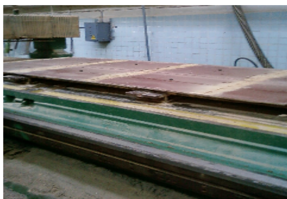
Рис. 4. Механическая обработка трехслойной сотовой панели на станке РФП-6
