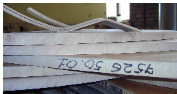
Рис. 5. Трехслойные сотовые панели интерьера самолета Як-40 с торцами, заделанными полимерным заполнителем ВПЗ-15
