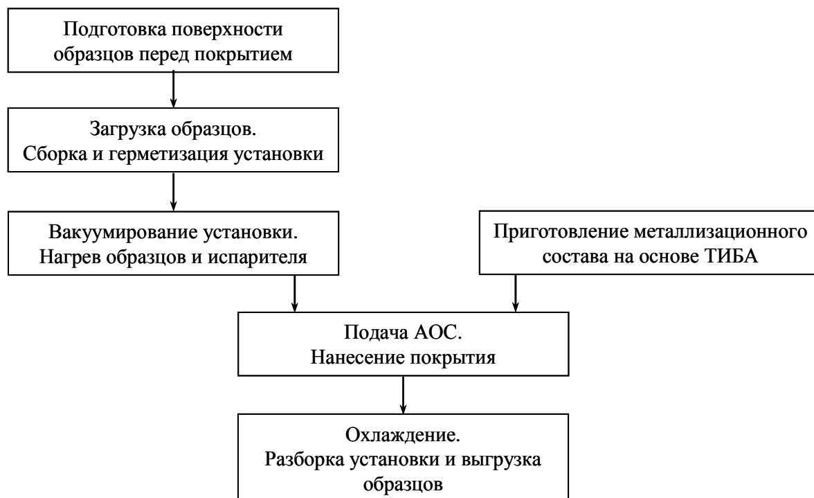
Рис. 3. Схема технологического процесса получения ПАП ПАП на опытно-промышленной установке
