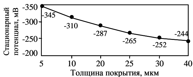
Рис. 1. Зависимость величины стационарных потенциалов никель-кобальтовых покрытий, полученных в электролитах без нанопорошков, от их толщины
