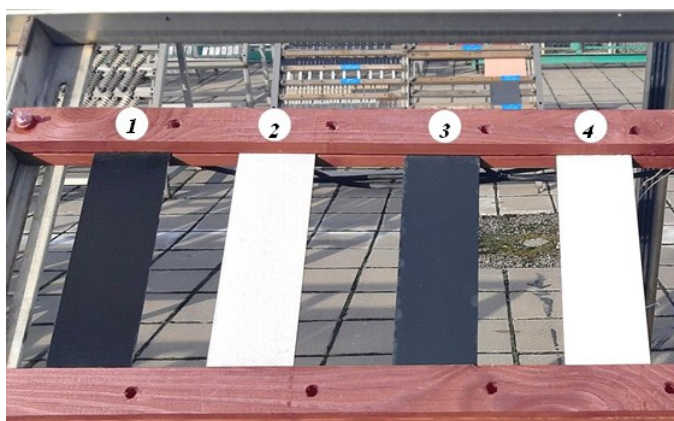
Рис. 1. Внешний вид образцов углепластика КМКУ-3.150.Э0.1 (1), стеклопластика КМКС-4.175.Т10 (2) и алюминиевого сплава Д16-АТ с покрытием ЭП-140 черного (3) и белого (4) цвета, снабженных термодатчиками температуры поверхности при экспонировании на открытом стенде МЦКИ ВИАМ
