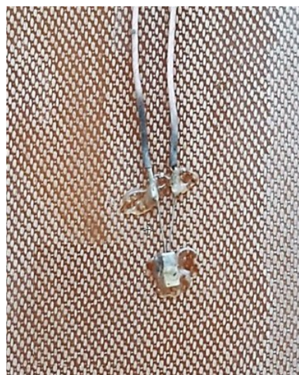
Рис. 2. Термодатчик, закрепленный на необлучаемой Солнцем поверхности стеклопластика КМКС-4.175.Т10
