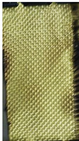
Рис. 5. Выгорание поверхности ткани
