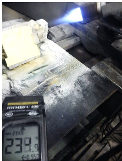
Рис. 4. Газопламенное напыление СВМПЭ
