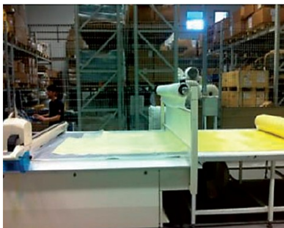
Рис. 1. Этап формирования ламината из арамидной ткани и СВМПЭ [6]
