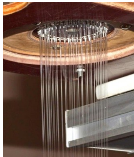
Рис. 4. Формование сырого волокна методом экструзии через многокапиллярную фильеру [33]
