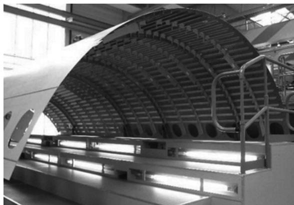
Рис. 3. Верхняя обшивка фюзеляжа самолета А-380 из материала GLARE [3]
