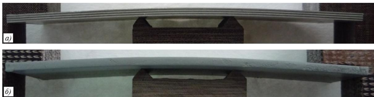
Рис. 9. Торцы образцов из материала СИАЛ-3-1 при испытаниях на четырехточечный изгиб:
