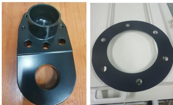
Рис. 5. Фотографии деталей вертолета с катодным электрофоретическим покрытием
