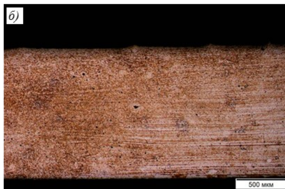
Рис. 5. Микроструктура ( \times 50 ) сварных соединений сплава В-1469-Т со стороны набегания (а) и выхода инструмента (б)
