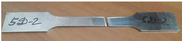
Рис. 7. Сварной образец, разрушенный при испытаниях на растяжение
