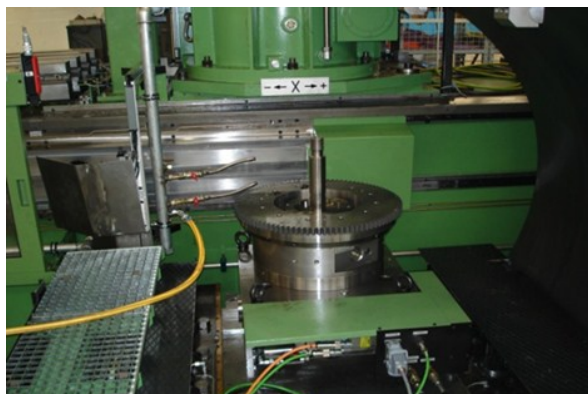
Рис. 3. Устройство типа STARK Speedy 2000 для быстрой установки и закрепления делительного стола
