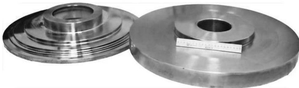
Рис. 1. Внешний вид штамповок дисков из сплава ВЖ175-ИД для двигателя ПД-14
