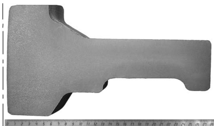
Рис. 2. Макроструктура крупногабаритной штамповки диска из сплава ВЖ175-ИД
