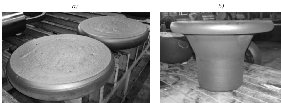
Рис. 6. Заготовки дисков (а) и вала (б) для сварного ротора компрессора высокого давления
