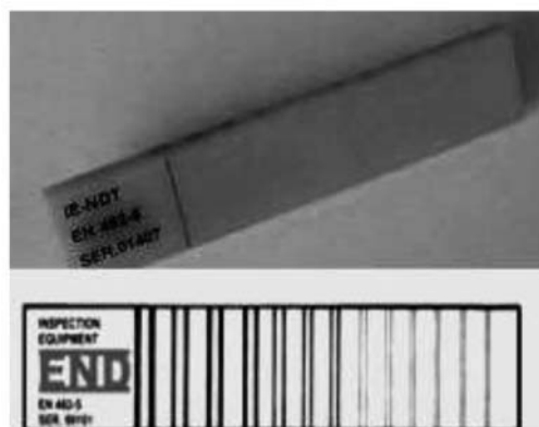
Рис. 6. Внешний вид дуплексного индикатора качества изображения (ИКИ)
