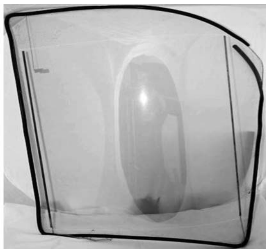
Рис. 7. Типовая деталь лобового остекления вертолета размером 1000 \times 900 \text{ мм}
