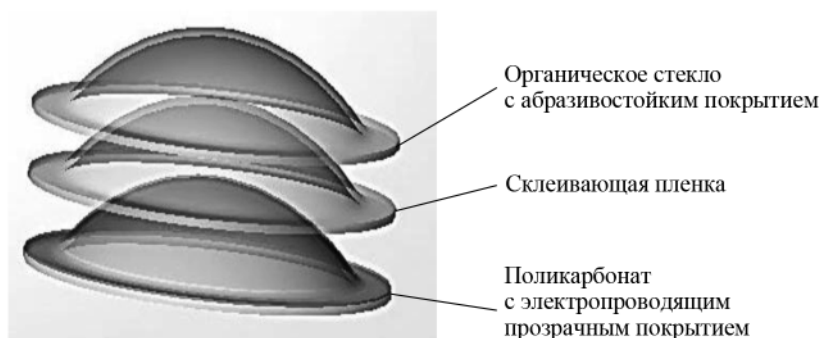
Рис. 6. Схема многослойного остекления
