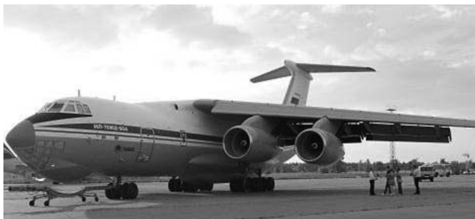
Рис. 1. Внешняя окраска самолета эмалями ВЭ-69 и ВЭ-71
