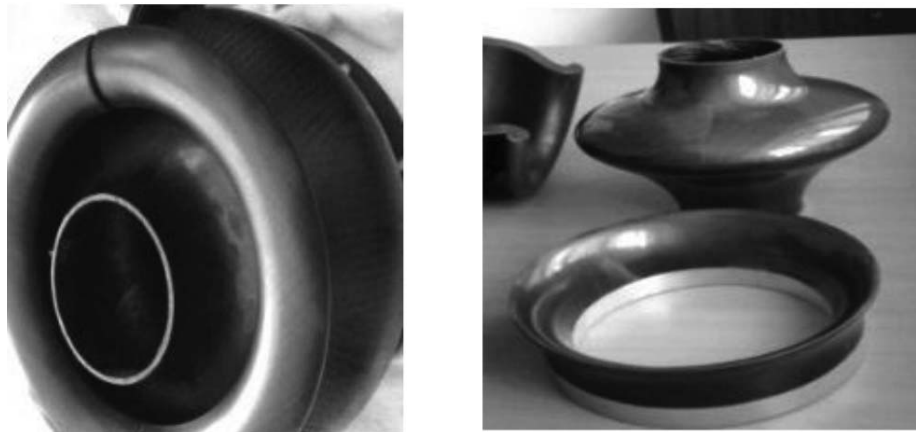
Рис. 4. Элементы пылезащитного устройства, изготовленного из углепластика марки ВКУ-42 с плакирующим слоем из органопластика
