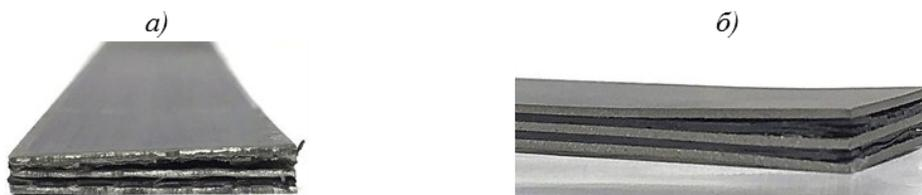
Рис. 3. Расслоение титанопolyмерных материалов при изготовлении заготовок и образцов рубкой на гильотинных ножницах (а) и фрезеровкой под готовый образец (б)
