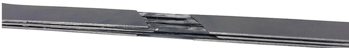
Рис. 5. Разрушенный образец титанополимерного слоистого материала при испытаниях на растяжение
