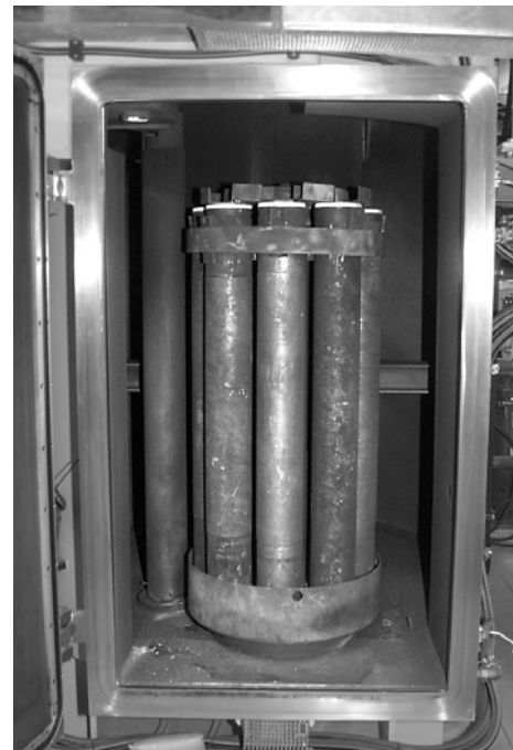
Рис. 4. Система разливки металла в трубы на установке VIM-50
