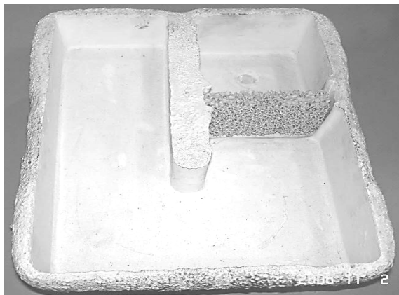
Рис. 3. Промежуточный ковш с установленным пенокерамическим фильтром
