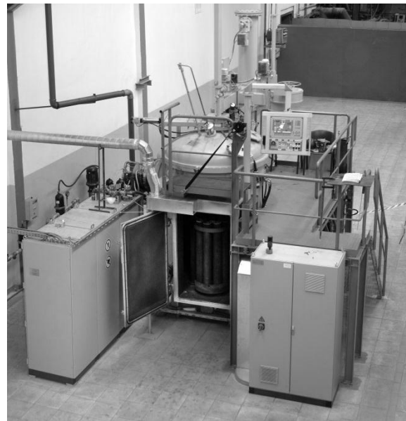
Рис. 2. Общий вид вакуумной плавильной установки VIM-50
