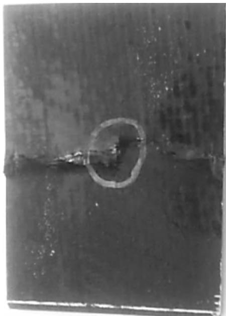
Пример разрушения образца в результате испытаний на сжатие после ударного воздействия (цветом выделена область расслоения после ударного воздействия)
